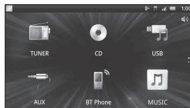
Para seleccionar otra fuente o aplicación, presione SRC y luego gire el selector de control para seleccionar la fuente o aplicación que deseé.
