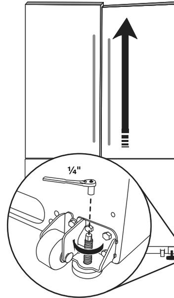
6. Asegúrese de que el refrigerador esté estable. Si el refrigerador parece inestable o se desliza hacia delante cuando se abre la puerta o el cajón, regule los tornillos niveladores. Gire el tornillo nivelador de cada lado hacia la derecha con una llave hexagonal de  $\frac{1}{4}$ " hasta que los rodillos estén hacia arriba y las patas niveladoras estén firmes contra el piso.
