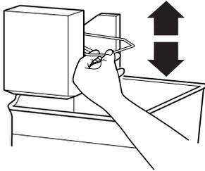
**NOTA:** Apague la fábrica de hielo antes de quitar el depósito de hielo para limpiarlo o para servir hielo. Esto evitará que los cubos de hielo se caigan y salgan de la fábrica de hielo hacia el compartimiento del congelador. Encienda la fábrica de hielo después de volver a colocar el depósito de hielo.
