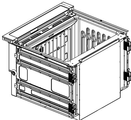
2. Retirer le pied de la cale d'espacement avant droite en ôtant la vis n° 8-18 x 3/8".
