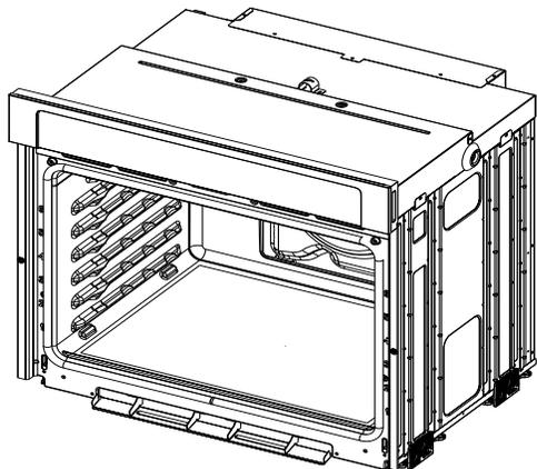
**La hauteur de la cavité d'encastrement est comprise entre 26<sup>15</sup>/<sub>16</sub>" et 27<sup>1</sup>/<sub>16</sub>" (68,4 cm et 70,3 cm)**
