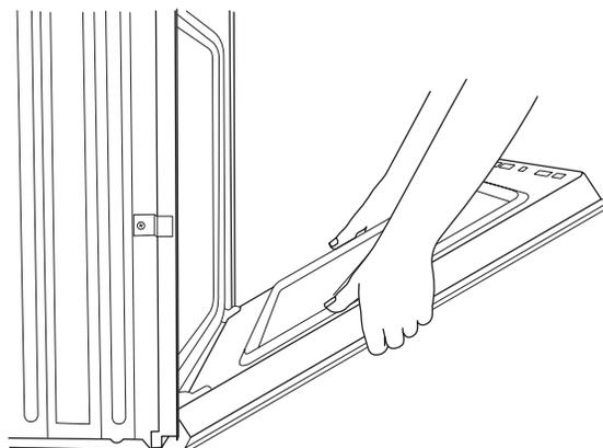
5. Saisir les bords de la porte du four avec les deux mains. Soulever et tirer la porte du four vers soi et enlever la porte. Vous devez peut-être basculer doucement la porte d'un côté et de l'autre en la tirant.
