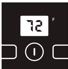
La unidad está programada para que encienda en modo de ahorro de energía, con la velocidad automática del ventilador y una temperatura establecida en 72 °F. ENERGY STAR exige estos valores por cuestiones de máxima eficiencia energética. Recomendamos solo utilizar los botones de temperatura para controlar la comodidad de la habitación.
