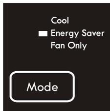
Ahorrrará energía usando el aparato en este modo. El compresor y el motor se apagarán una vez que la habitación esté a la temperatura seleccionada. Después la temperatura del aire será comprobada durante 20 segundos cada 10 minutos hasta que se eleve por encima de la selección, momento en el cual el compresor y el ventilador volverán a funcionar. El proceso completo se repetirá entonces.
