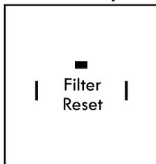
Tras 250 horas de funcionamiento, el indicador LED de "Reseteo del Filtro" se encenderá. Es un recordatorio para limpiar el filtro alojado tras el panel frontal y así mantener la unidad funcionando eficientemente. Al presionar el botón RESETEO DEL FILTRO durante 3 segundos este recordatorio se reseteará y el LED se apagará.
