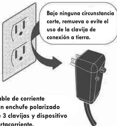
Cable de corriente con enchufe polarizado de 3 clavijas y dispositivo cortacorriente.
