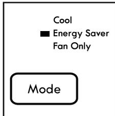
Ahorrrará energía usando el aparato en este modo. El compresor y el motor se apagará una vez que la habitación esté a la temperatura seleccionada. Después la temperatura del aire será comprobada durante 20 segundos cada 10 minutos hasta que se eleve por encima de la selección, momento en el cual el compresor y el ventilador volverán a funcionar. El proceso completo se repetirá entonces.
