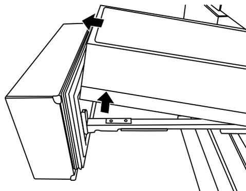
2. Para el cajón izquierdo, retire la cubierta de la conexión del cableado. Presione en el costado de la cubierta para liberar la lengüeta desde la ranura y retire la cubierta desde el soporte.
