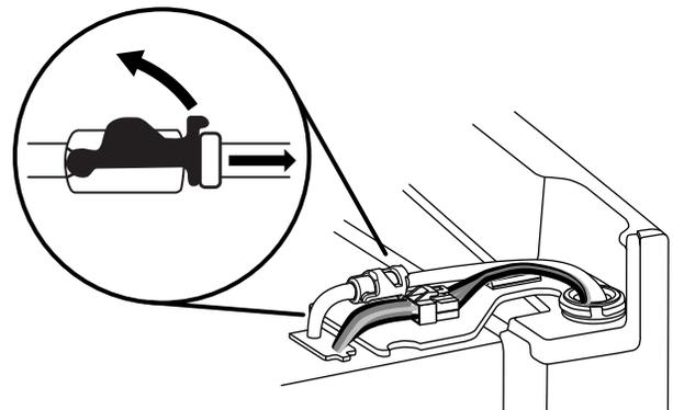
3. Desconecte el enchufe de cableado que está ubicado en la parte superior de la bisagra de la puerta.
