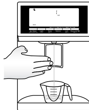
4. Cuando se haya despachado correctamente 1 taza de agua en la taza medidora, presione el botón de MEASURED FILL (Llenado medido) bajo la palabra "Confirm" (Confirmar) para confirmar el calibrado.
