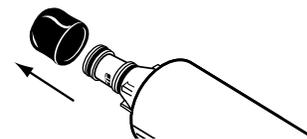
4. Deslice la tapa del filtro sobre el nuevo filtro de agua. Vea la ilustración en el Paso 2.
