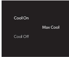
Max Cool (Frío máximo) volverá a ajustar la temperatura del cajón refrigerador en 32 °F (0 °C) y -3 °F (-19 °C) para el cajón congelador por un período de 24 horas.
