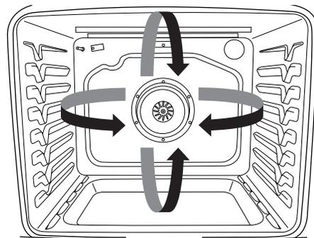
Durant la cuisson ou le rôtissage par convection, les éléments de cuisson au four, cuisson au gril et de convection s'allument et s'éteignent par intermittence tandis que le ventilateur fait circuler l'air chaud.
