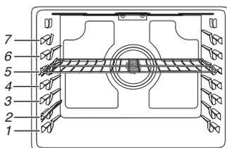
Le four possède de 7 positions pour grille plate, comme indiqué dans l'illustration précédente et le tableau suivant.
