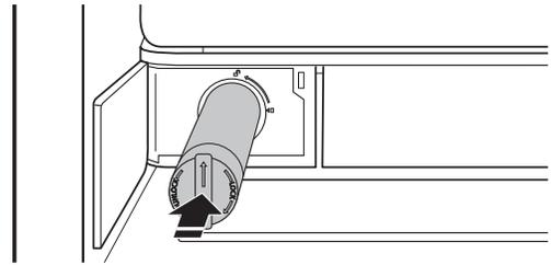
7. Faire tourner le filtre de 90° dans le sens horaire jusqu'à ce qu'il soit verrouillé en place et que les flèches soient alignées.
