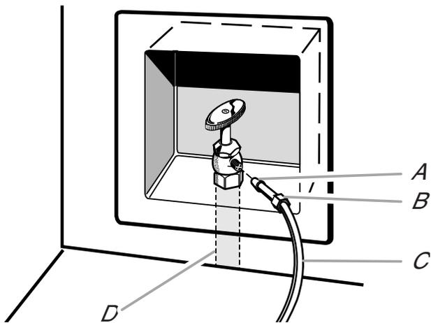
A. Bague C. Canalisations en cuivre (jusqu'au réfrigérateur)
