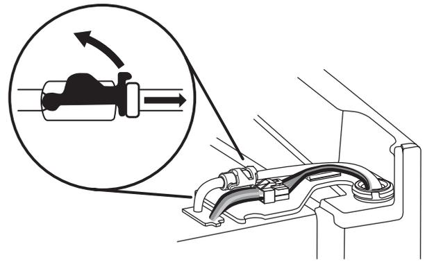
3. Débrancher le câblage situé sur la charnière de la porte.
