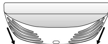
3. Remplacer l'ampoule grillée par une ampoule pour appareils électroménagers de 25 watts maximum.
