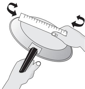
Para obtener los mejores resultados, los utensilios deben tener fondo plano y deben quedar completamente nivelados sobre la rejilla del quemador. Antes de usar un utensilio, verifique si su fondo es plano haciendo una regla sobre este (Figura 8).
