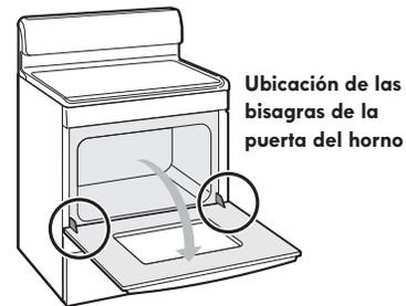
Figura 84: Ubicación de la bisagra del horno
