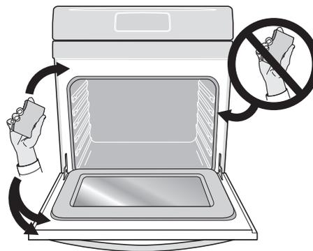
Figura 73: Partes de la puerta del horno que deben y no deben limpiarse (junta)
