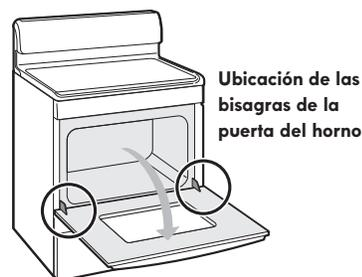
Figura 58: Ubicación de la bisagra del horno
