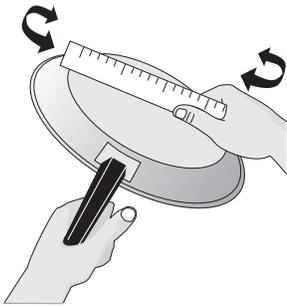
Para obtener los mejores resultados, los utensilios deben tener fondo plano y deben quedar completamente nivelados sobre la rejilla del quemador. Antes de usar un utensilio, verifique si su fondo es plano haciendo una regla sobre este (Figura 7).
