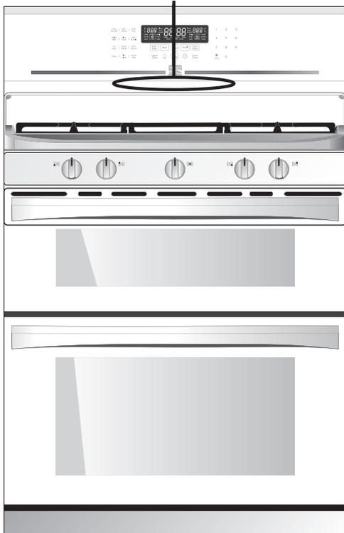
Figura 12: Ubicación del respiradero del horno
