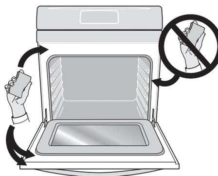
**Figura 47: Partes de la puerta del horno que deben y no deben limpiarse (junta)**
