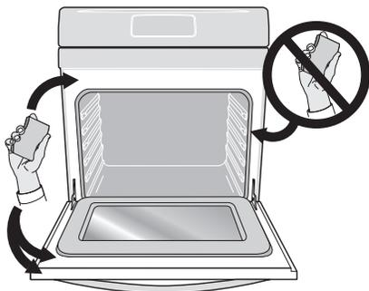
Figura 41: El área de la puerta del horno que se debe y no se debe limpiar (junta).
