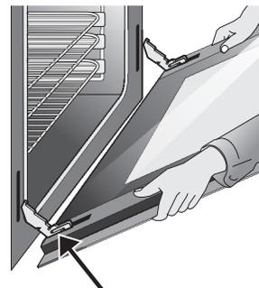
Figura 51: Ubicación de los pasadores cilíndricos de la bisagra
