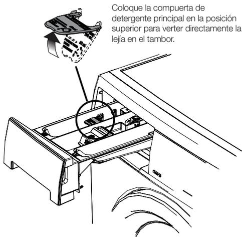
Coloque la compuerta de detergente principal en la posición superior para verter directamente la leja en el tambor.
