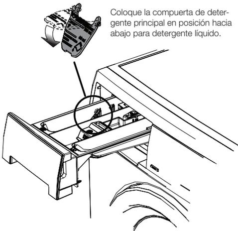
Coloque la compuerta de detergente principal en posición hacia arriba para detergente en polvo.
