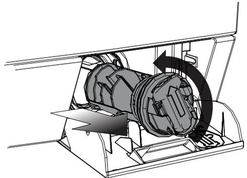
Inspeccione la junta tórica antes de reinsertar el filtro de la bomba.
