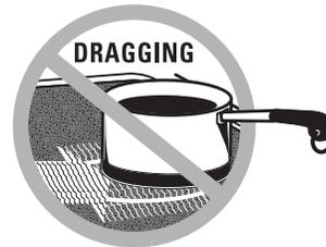
No deslice los recipientes de cocción a través del control y la superficie de la estufa porque puede rayar el vidrio. El vidrio es resistente a los rayones, pero no a prueba de los mismos.
