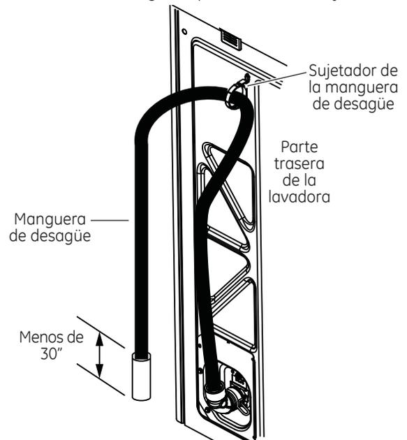
**NOTA:** Colocar la manguera de drenaje muy debajo de la tubería de drenaje puede provocar un efecto de sifón. No debe haber más de 5 pulgadas de manguera en la tubería de drenaje. Debe haber un espacio de aire alrededor de la manguera de drenaje. Si la manguera está muy ajustada, también puede provocarse un efecto de sifón.
