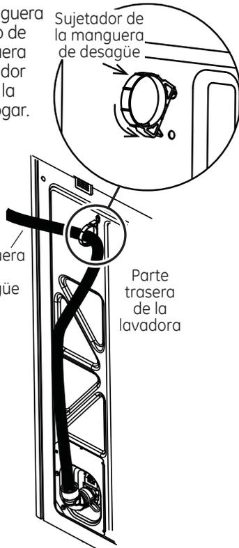
Si las válvulas de agua y el drenaje están adheridos a la pared, ajuste la manguera de desagüe a una de las mangueras de agua con el enlace para cable provisto.
