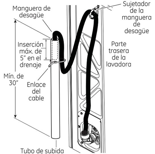
**NOTA:** Colocar la manguera de drenaje muy debajo de la tubería de drenaje puede provocar un efecto de sifón. No debe haber más de 5 pulgadas de manguera en la tubería de drenaje. Debe haber un espacio de aire alrededor de la manguera de drenaje. Si la manguera está muy ajustada, también puede provocarse un efecto de sifón.
