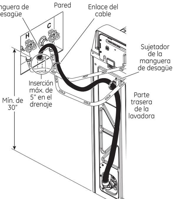
**NOTA:** Colocar la manguera de drenaje muy debajo de la tubería de drenaje puede provocar un efecto de sifón. No debe haber más de 5 pulgadas de manguera en la tubería de drenaje. Debe haber un espacio de aire alrededor de la manguera de drenaje. Si la manguera está muy ajustada, también puede provocarse un efecto de sifón.
