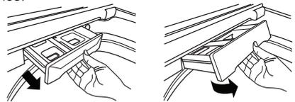
1. Tire del cajón hacia fuera hasta que se detenga. Levante el frente del cajón y tire hacia fuera.
