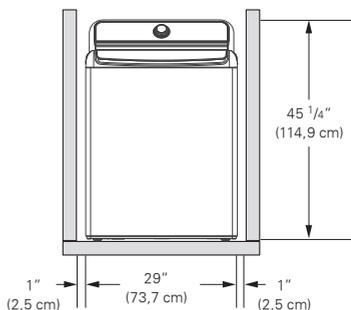
Deje espacio suficiente para las tuberías de agua y el flujo del aire. Mínimo 1 pulgada (2,5 cm) a los lados y 4 pulgadas (10 cm) en la parte trasera. Asegúrese de tener en cuenta molduras de paredes, puertas o suelo por si desea aumentar el espacio requerido.
