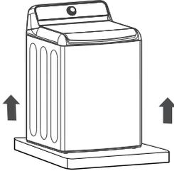
Si debe inclinar la lavadora para quitar los materiales de embalaje de la base, hágalo siempre cuidadosamente sobre su parte lateral. NO incline la lavadora sobre la parte frontal o posterior.
