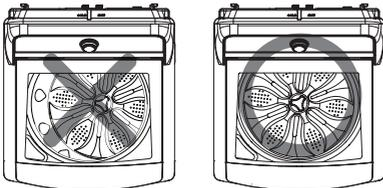
3. Para asegurarse de que la lavadora esté nivelada adecuadamente, abra la puerta y compruebe desde arriba que el tambor está centrado. Si el tambor no está centrado, (como se muestra en el dibujo tachado con la X), reajuste las patas delanteras. Si tiene un nivel, compruebe que la lavadora esté nivelada.
