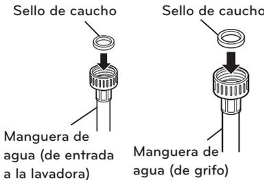
1. Revise la conexión roscada las mangueras y asegúrese de que haya una junta de goma en ambos extremos de cada manguera.
