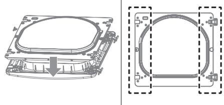
6. Vuelva a colocar la puerta utilizando los tornillos del paso 1,2.
