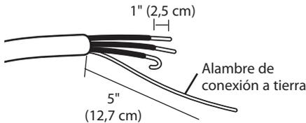
2. Quite la cubierta de acceso al bloque terminal localizado en la parte superior trasera de la secadora. Instale un protector de tensión listado por UL en el orificio de pase del cable eléctrico; luego pase el cable eléctrico fabricado en el Paso 1 por el protector de tensión.
