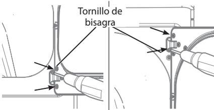
3. Con la puerta colocada sobre una superficie protegida, retire los 12 tornillos de cada lado de la puerta y retire el panel interior de la puerta con un destornillador de punta plana. Retire el enganche y la pieza, y llévelas al lado opuesto.
