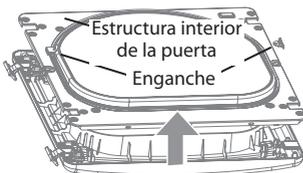
4. Retire los 4 tornillos fijando las bisagras a la estructura de la puerta. Retire los dos rellenos de plástico. Vuelva a instalar las bisagras y los rellenos en los lados opuestos a su posición inicial.
