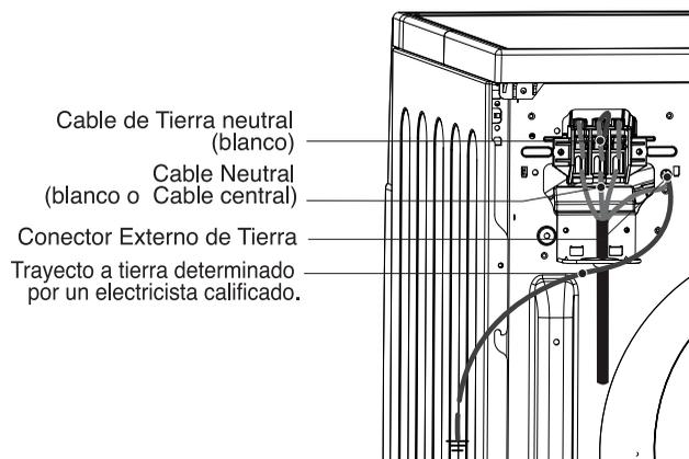
1. Conecte un cable neutral (blanco) al cable de poder para centrar la terminal del tornillo.
