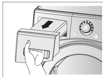
2. Tire del asa de la parte frontal del cajón para extraer el depósito.
