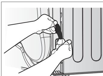
2. Desconecte la manguera que va hasta el depósito.
