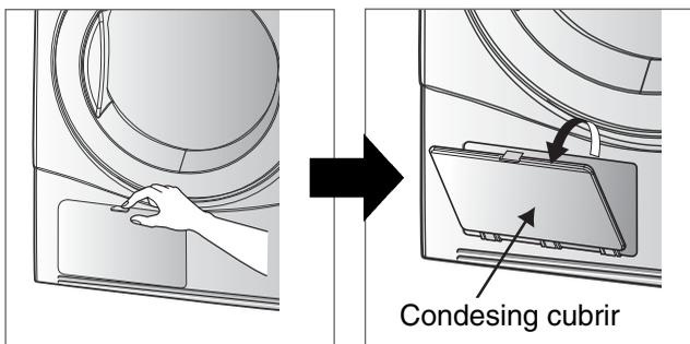
2. Gire las palancas de bloqueo en un lado y otro de la placa interna para desbloquearla. A continuación, extraiga la placa de la abertura.
