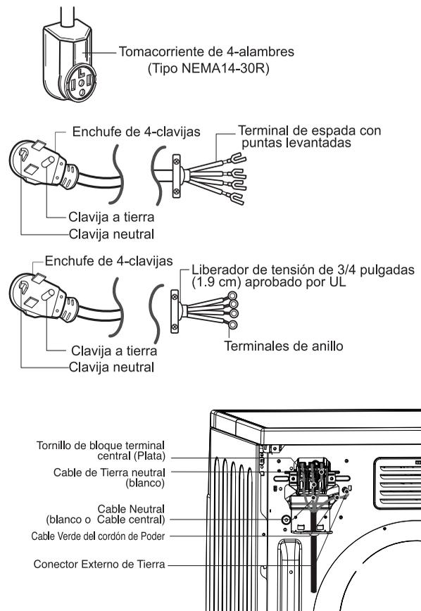
1. Conecte un cable neutral (blanco) al cable de poder para centrar la terminal del tornillo.
