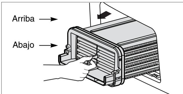
4. Coloque el condensador bajo agua corriente para lavarlo bien, tanto laterales como los extremos.
