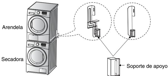
Esta secadora sólo se podrá colocar en columna sobre una lavadora LG. NO intente colocar esta secadora en columna sobre otras lavadoras, ya que podrían producirse desperfectos, lesiones o daños a la propiedad.
