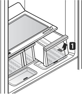
Para instalarlo, incline la parte delantera ligeramente hacia arriba, inserte el cajón en el marco y empuje hasta que encaje en su sitio.
