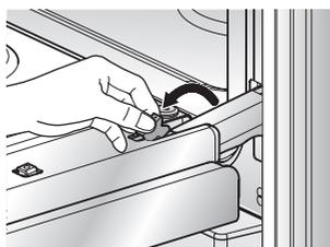
3. Cierre la puerta a 30 grados (notará el tope e la puerta). El cierre de la bisagra hará contacto con el marco del horno.
