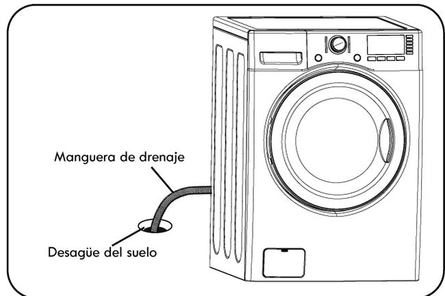
Inserte el extremo de la manguera de drenaje en el desagüe del suelo. Si es posible, fije la manguera para evitar que se mueva o se salga del desagüe.
