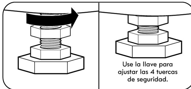
3. Una vez que la lavadora esté nivelada de lado a lado y de adelante hacia atrás, utilice la llave para apretar las cuatro tuercas de fijación y fijelas a fin de evitar que las patas se desajusten durante el funcionamiento. Asegúrese de que las cuatro patas estén en contacto directo con el suelo.
