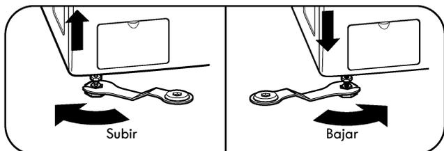
2. Afloje las tuercas de fijación de las cuatro patas de nivelación con la llave hasta que ajuste las patas (aspecto llave puede variar). Utilice la llave para girar las patas hacia la derecha para elevar la lavadora, y en sentido contrario para bajar la lavadora. Con un nivel, ajuste las patas hasta que la lavadora quede nivelada de lado a lado y de adelante hacia atrás. Asegúrese de que las cuatro patas estén en contacto directo con el suelo.
