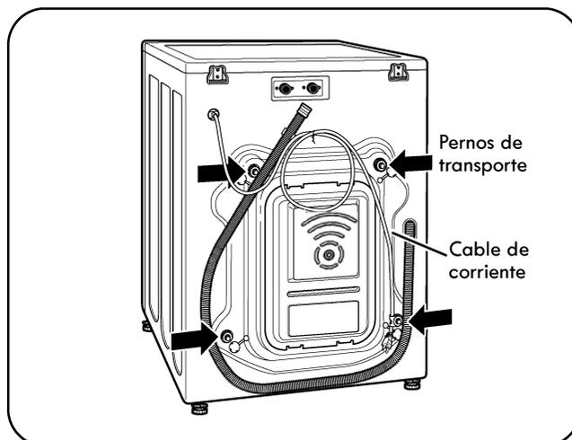
1. Comience con los dos pernos de transporte inferiores y utilice la llave de pernos (incluida) para aflojar completamente los cuatro pernos de transporte girándolos hacia la izquierda.
