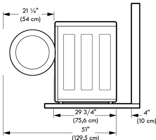
Para asegurar que se haya dotado de suficiente espacio para las tuberías de agua y flujo de aire, deje espacios mínimos de por lo menos 2,5 cm (1 pulgada) en los lados y de 10 cm (4 pulgadas) detrás de la unidad. No olvide tener en cuenta las molduras de paredes, puertas o piso, que podrían aumentar la distancia de separación necesaria.
