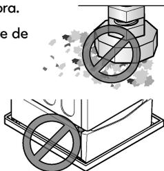
**NOTA:** Si debe utilizar una bandeja recolectora, asegúrese de seguir las instrucciones incluidas con la bandeja recolectora y de que las patas de nivelación estén ajustadas para un contacto firme y nivelado con la bandeja. El uso de bandejas recolectoras y la nivelación inadecuada de la máquina pueden resultar en una mayor vibración y ruido durante el funcionamiento.
