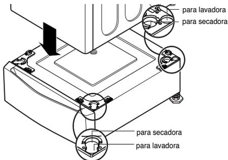
**NOTA:** las patas de la lavadora y la secadora no son iguales, por lo que los huecos de las abrazaderas de la parte superior del pedestal son alargados. Consulte la ilustración anterior para identificar las distintas ubicaciones para las patas de la lavadora y la secadora. Si las patas no se encuentran en las ubicaciones correctas, el electrodoméstico no quedará bien alienado y no podrá fijarse al pedestal.
