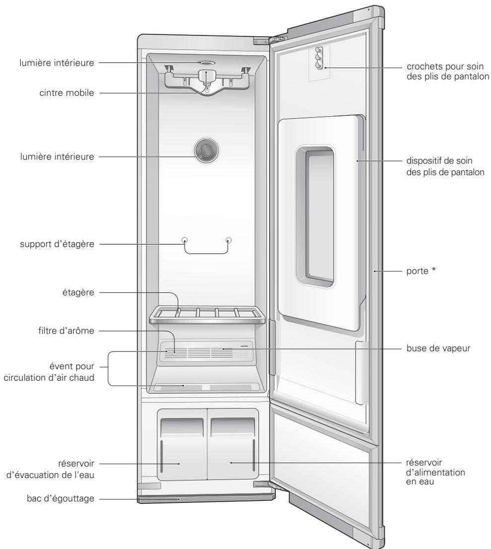
\* Le sens d'ouverture de la porte peut être inversé par l'installateur pour adapter l'appareil à l'emplacement d'installation.
