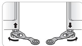
Soulevez ou abaissez l'appareil en utilisant les pieds de nivellement jusqu'à ce que le Styler soit à niveau à gauche, à droite, à l'avant et à l'arrière.
