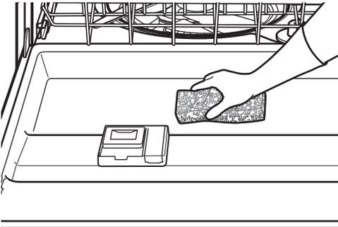
Los residuos minerales del agua dura pueden causar la acumulación de una película blanca en las superficies interiores, sobre todo inmediatamente debajo del área de la puerta.
