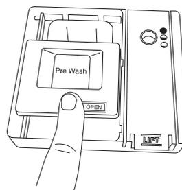
Coloque el detergente seleccionado en el dispensador. Coloque el dedo, como se muestra, y deslice la tapa para cerrar. Presione firmemente hasta escuchar un chasquido.
