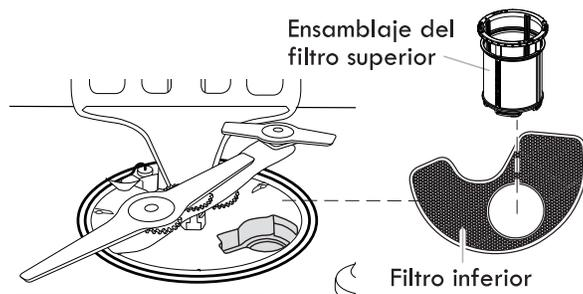
Para proveer un desempeño óptimo de limpieza, sugerimos un mantenimiento mensual del filtro, removiendo e inspeccionando los filtros superior e inferior para ver si están sucios. Según sus hábitos con la lavavajillas, deberá limpiar los filtros con más o menos frecuencia que lo indicado en la tabla a continuación.
