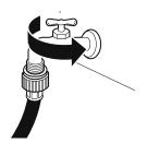
5 Verifique que no haya fugas en el conector en "Y" (si se utiliza) ni en ninguna otra manguera.
