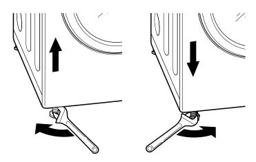
Use una llave inglesa para girar los pies de nivelación. Gire el pie de nivelación en sentido horario para elevar la secadora y gírelo en sentido antihorario para bajarla. Con un nivel, ajuste los pies hasta que la secadora quede nivelada de lado a lado y de adelante hacia atrás. Asegúrese de que los cuatro pies están en contacto directo con el suelo.
