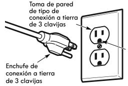
Asegúrese de que dispone de una conexión a tierra adecuada antes de ponerla en funcionamiento.
