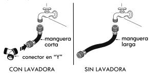
Apriete bien todas las conexiones de las mangueras de suministro de agua a mano y luego ajuste otros 2/3 de vuelta con pinzas.
