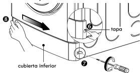
Retire los tornillos que sujetan la cubierta de seguridad en su lugar y deje los tornillos y la cubierta a un lado.
