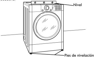
Coloque la secadora en su ubicación final. Coloque un nivel sobre la parte superior de la secadora.
