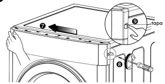
Oriente los ganchos de la placa superior de modo que estén alineados con los orificios de la carcasa.
