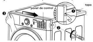
Deje caer el panel hacia abajo y desconecte el mazo de cables. Retire el panel y déjelo a un lado.
