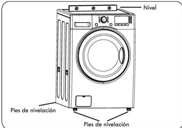
1. Coloque la lavadora en su ubicación final, teniendo especial cuidado de no presionar, tirar excesivamente o aplastar las tuberías de agua y drenaje. Coloque un nivel sobre la parte superior de la lavadora.
