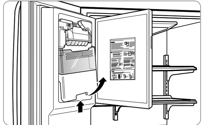
3. Pour réinstaller le bac à glaçons dans la porte, inclinez légèrement le bac pendant la remise en place pour éviter tout contact avec la machine à glaçons.
