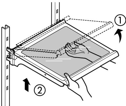
**Pour réinstaller une étagère**—Inclinez l'avant de l'étagère vers le haut et introduisez les crochets de l'étagère dans les fentes à la hauteur souhaitée. Ensuite, abaissez l'avant de l'étagère afin que les crochets se positionnent dans les fentes.
