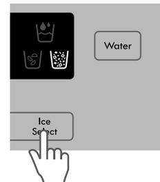
**ATTENTION :** L'affichage de contrôle est doté d'une commande tactile. Une humidité excessive sur l'affichage peut causer un dysfonctionnement. Maintenez l'affichage propre et sec.
