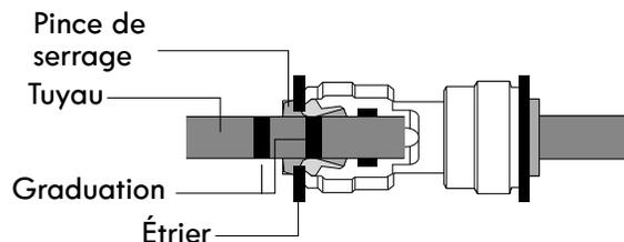
Après insertion, tirez le tuyau pour vérifier qu'il est bien fixé et réinsérez l'étrier.
