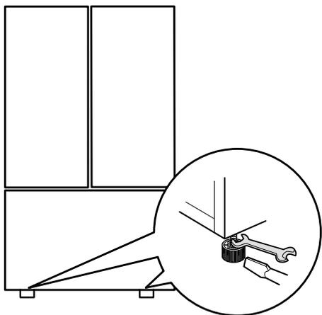
**REMARQUE :** Demandez à une personne de pousser vers l'arrière le haut du réfrigérateur pour retirer une partie du poids sur les cales de réglage. Cela simplifie le réglage des cales.
