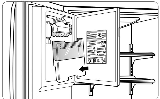
4. Évitez de toucher le capteur de détection de glace lors de la remise en place du bac à glaçons. Pour plus de détails, reportez-vous à l'étiquette sur la porte du compartiment à glaçons.
