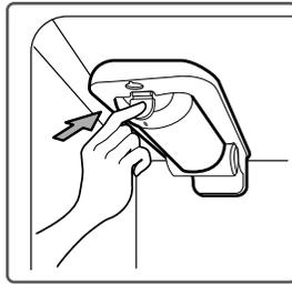
**REMARQUE :** Le remplacement du filtre à eau entraîne l'écoulement d'une petite quantité d'eau (environ 1 once ou 25 cc). Placez une tasse sous l'extrémité avant du couvercle du filtre à eau pour recueillir tout écoulement d'eau. Tenez le filtre à eau à la verticale, une fois qu'il est retiré, pour empêcher tout écoulement d'eau du filtre à eau.
