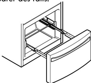
Des deux mains, tenez la barre centrale et poussez-la vers l'intérieur pour permettre aux deux rails de glisser vers l'intérieur simultanément.
