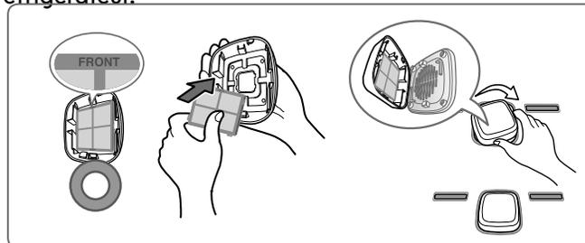
Après avoir changé le filtre d'air, appuyer pendant trois secondes sur le bouton du Filtre d'air pour réinitialiser le senseur du filtre.
