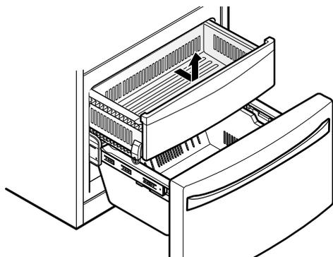
2. Pour remettre en place, inclinez légèrement l'avant du tiroir vers le haut, insérez le tiroir dans le châssis, puis poussez le tiroir en place.
