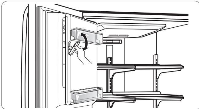
2. Para sacar el depósito de hielo del interior de la puerta, agarre la manija delantera, levante ligeramente la parte inferior y despegue el depósito tal como se muestra.
