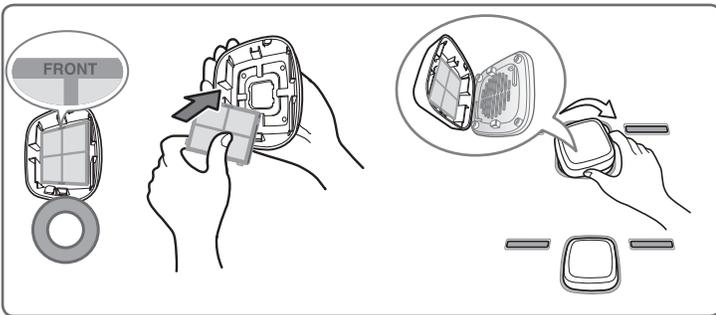
Luego de cambiar el filtro, mantenga pulsado el botón Air Filter durante tres segundos para restablecer el sensor del filtro.
