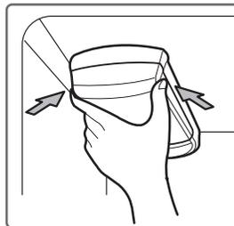
**NOTA:** Al reemplazar el filtro de agua se drena una pequeña cantidad de agua (unos 25 cc). Coloque un vaso debajo de la parte delantera de la tapa del filtro de agua para recoger el agua que se escape. Sostenga el filtro de agua en posición vertical, una vez retirado, para evitar que el agua residual se salga del filtro de agua.
