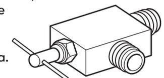
**NOTA:** No se debe usar una válvula de agua de tipo de montura autopercutor.
