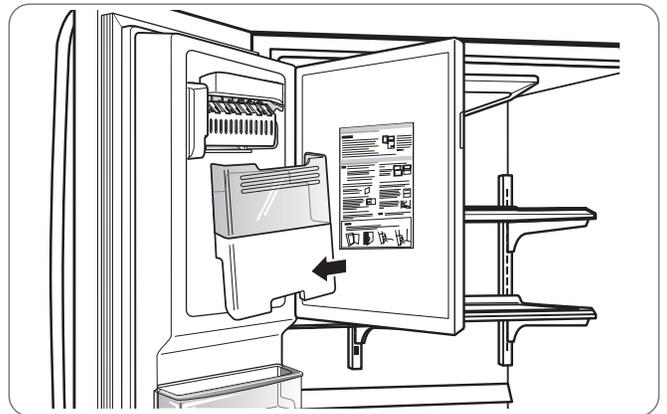
4. Evite tocar el apagado automático (brazo palpador) al colocar el recipiente del hielo. Consulte la etiqueta que hay en la puerta del compartimiento de hielo para obtener información más detallada.
