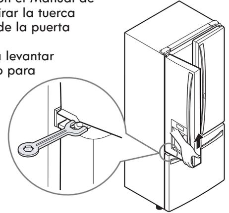
**La puerta derecha del refrigerador no tiene una tuerca ajustable.**
