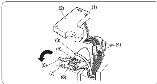
1. Abra la puerta. Retire el tornillo de la tapa de la bisagra superior (1).
