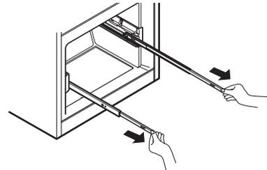
Sujete el cajón por cada lado y enganche los soportes de la puerta **1** para introducirlos en las pestañas de los rieles **2** que hay a ambos lados.
