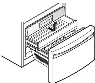
2. Para volver a colocarlo, incline la parte delantera del cajón ligeramente hacia arriba, inserte el cajón en el marco y empuje hasta que encaje en su sitio.
