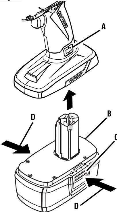
A - C3 energy indicator window (visor del indicador de energía C3)
