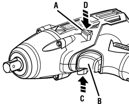
A - Direction of rotation selector (forward/reverse/center lock) [selector de sentido de rotación (adelante/atrás seguro en el centro)]
