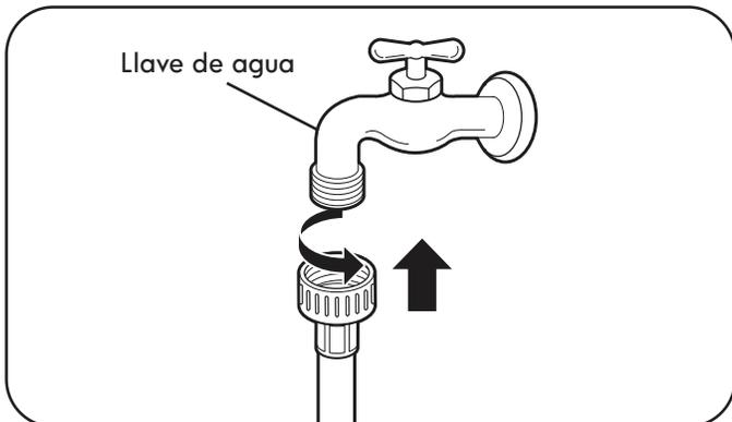
2. Conecte las mangueras de suministro de agua a las llaves de paso de agua caliente y fría y apriete las conexiones con la mano. A continuación, utilice unos alicates para apretarlas otros  $\frac{2}{3}$  de vuelta.
