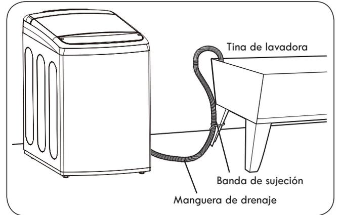
Doble el extremo de la manguera de drenaje hasta que tenga la forma deseada y engánchelo al borde del lavadero. Use una correa para asegurar la manguera de drenaje en su lugar.
