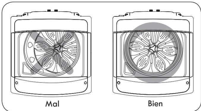
3. Para asegurarse de que la lavadora está correctamente nivelada, abra la tapa y mire desde arriba para ver si la tina está centrada. Si la tina NO está centrada como muestra el dibujo a la izquierda, vuelva a ajustar la pata. Si tiene un nivel, compruebe la lavadora con el nivel.
