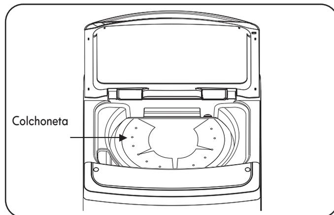
3. Retire cuidadosamente las dos protecciones de espuma que cubren los lados superiores de la guía de la cuba, asegurándose de no dejar ningún resto de espuma.
