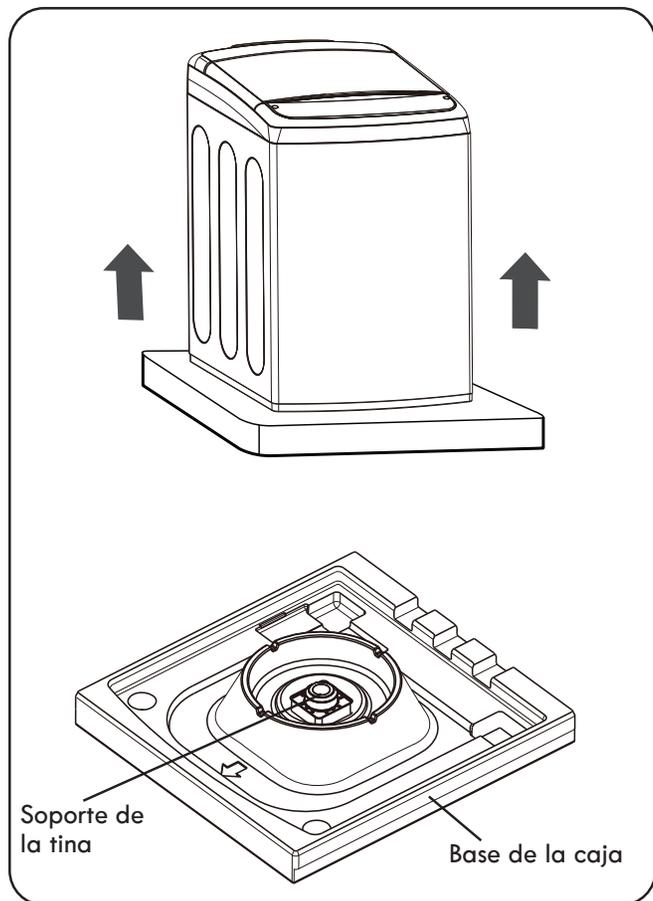
1. Después de quitar el cartón y el material de embalaje, levante y saque la lavadora de la base de espuma. Asegúrese de que el soporte de plástico de la tina sale con la base y no se queda atascado en la parte inferior de la lavadora.
