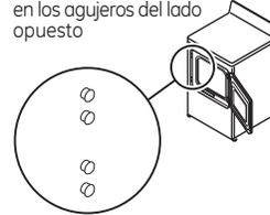
Desatornillar los tornillos inferiores de cada bisagra y atornillarlos en el lado opuesto en el orificio superior de cada bisagra solo la mitad del tornillo.
