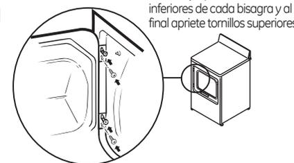
Atornille y apriete los tornillos inferiores de cada bisagra y al final apriete tornillos superiores.
