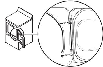
2 Afloje hasta la mitad el tornillo superior de cada bisagra de la cara de la secadora. Con una mano sosteniendo la parte superior de la puerta y con la otra mano sosteniendo la parte inferior, remueva la puerta de la secadora **LEVANTÁNDOLA** y **HALÁNDOLA**.
