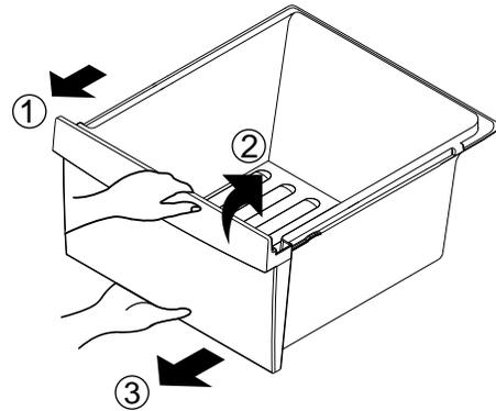
**⚠ PRECAUCIÓN:** Verá el tanque de agua mientras quita el cajón de vegetales. No quite el tanque de agua o puede ocurrir una fuga de agua. El tanque de agua no es una pieza removible.
