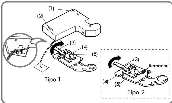
1. Abra la puerta. Retire el tornillo de la tapa de la bisagra superior (1).
