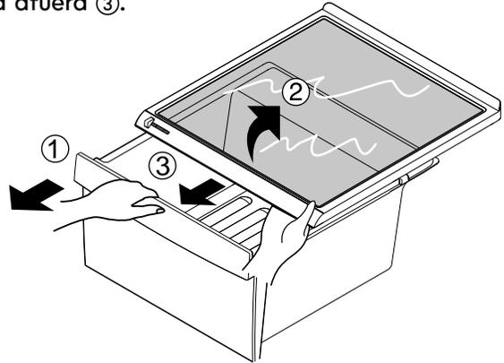
Para quitar el cajón de vegetales, abra el cajón de vegetales ① hasta que se detenga. Luego, levante levemente el cajón de vegetales ② mientras lo empuja hacia afuera ③.
