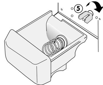
**NOTA:** Asegúrese de que el recipiente esté completamente encastrado en el accionamiento sinfín ⑤. Si no lo está, rote el accionamiento sinfín en la dirección que muestra la flecha hasta que el recipiente encastre por completo en el accionamiento sinfín.
