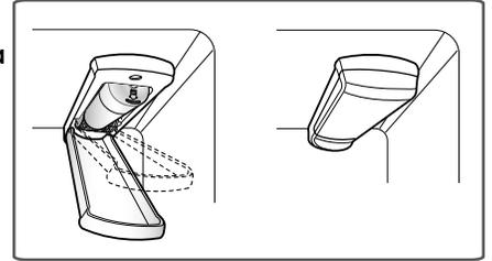
3. Después de reemplazar el filtro de agua, dispense 9,5 litros (2,5 galones) de agua (deje correr el agua durante unos 5 minutos) para purgar el aire atrapado y los contaminantes del sistema; no dispense los 9,5 litros (2,5 galones) de agua de manera continua. Pulse y suelte el botón del dispensador en ciclos de 30 segundos ON y 60 segundos OFF.
