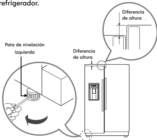
**NOTA:** Si una persona empuja hacia atrás la parte superior del refrigerador, descargará parte del peso de las patas de nivelación. Esta operación facilitará el ajuste de las patas.
