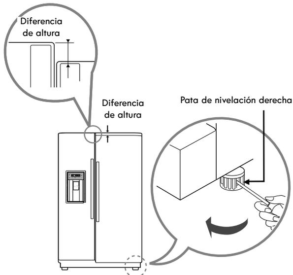
3. Vuelva a abrir ambas puertas y compruebe que se cierran con facilidad. Si no es así, incline el refrigerador ligeramente hacia atrás girando ambas patas de nivelación en sentido anti-horario. Es posible que sean necesarios más giros; debería girar ambas patas de nivelación la misma cantidad de veces.
