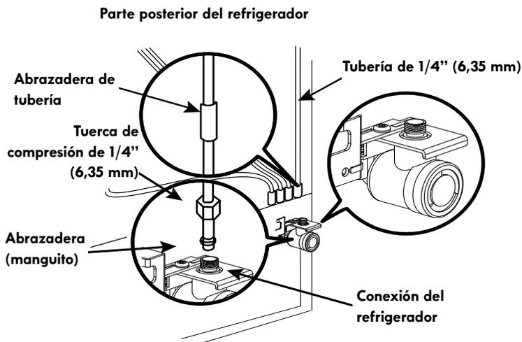
**10. ABRA EL PASO DE AGUA EN LA VÁLVULA DE CORTE**
