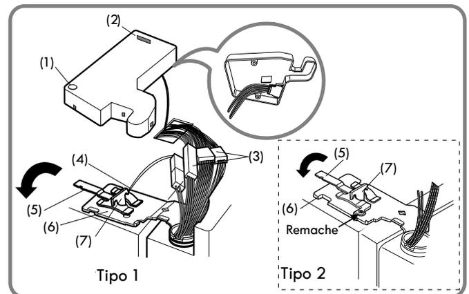
1. Abra la puerta. Retire el tornillo de la tapa de la bisagra superior (1).
