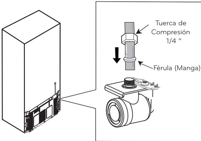
Apriete el tubo de conexión (casa) al sujetador de la parte trasera del refrigerador. Primero afloje el tornillo que sostiene el sujetador. Después, inserte el tubo de conexión de casa en el orificio. Finalmente, vuelva a apretar el tornillo.
