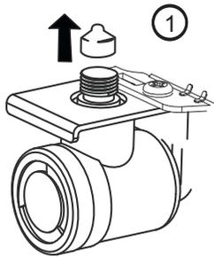
Coloque la tuerca de compresión y la férula al final de la tubería. Inserte la tubería en la válvula de conexión tan adentro como le sea posible. Apriete mientras sostiene la tubería.
