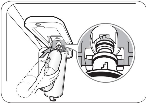
1. Extraiga el nuevo cartucho del embalaje y retire la cubierta de protección de la junta tórica. Con las aletas del cartucho en posición horizontal, empuje el nuevo cartucho en el orificio del distribuidor hasta que se detenga.
