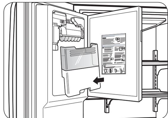
Para volver a colocar la charola para hielo en la puerta, incline ligeramente la charola para evitar el contacto con la máquina para hielo.
