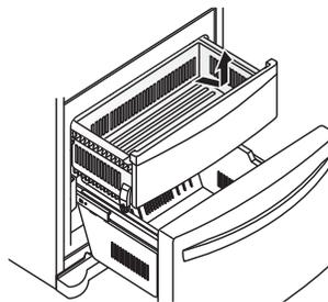
Para volver a instalarlo, tire hacia fuera y extienda ambos rieles. Inserte el extremo del saliente en la abrazadera a izquierda y derecha. Asegúrese de que las guías de la parte delantera estén correctamente alineadas y empújelas con cuidado hacia los dos laterales.
