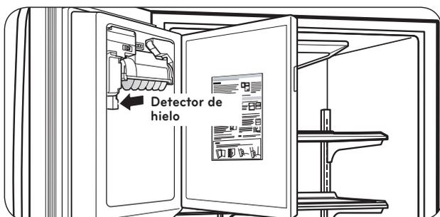
**NOTA:** Evite tocar el sensor de la cubitera al volver a colocar el depósito de hielo. Consulte la etiqueta de la puerta del compartimiento de hielo para conocer más detalles.
