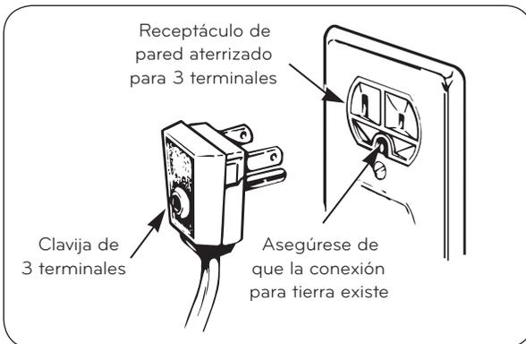
Se recomienda que se utilice un circuito separado para este producto, así como un receptáculo que no pueda ser desconectado con un interruptor. No utilice un cable de extensión.
