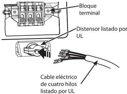
• Use un cable eléctrico de **30 A, 240 V, listado por UL con un conductor de cobre Núm.-10 AWG** como mínimo y terminales de circuito cerrado o de bifurcación con extremos doblados hacia arriba.
