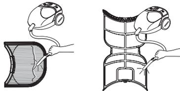
3. Si el filtro para pelusas se ha ensuciado mucho o se ha obstruido con suavizante de tejido, lávelo en agua caliente jabonosa y déjelo secar completamente antes de volverlo a colocar.
