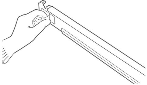
2. Haga coincidir la abrazadera lateral del lado de la parte superior de la lavadora como se indica en la ilustración anterior. Presione firmemente el área adhesiva de la abrazadera a la superficie de la lavadora. Asegure la abrazadera lateral a la lavadora con un tornillo en el lado trasero de la abrazadera.. Repita los pasos 1 y 2 para conectar la abrazadera del otro lado.
