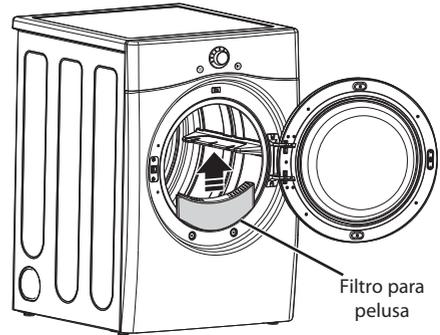
Para limpiarlo, abra la puerta de la secadora y tire del filtro para pelusa verticalmente. Luego:
