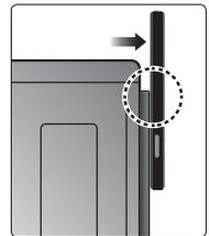
Para utilizar la función Tag On, coloque el smartphone de modo que la antena NFC de la parte trasera del smartphone coincida con el icono Tag On del aparato. Si no conoce la posición de su antena NFC, mueva el smartphone ligeramente de forma circular hasta que la aplicación verifique la conexión.
