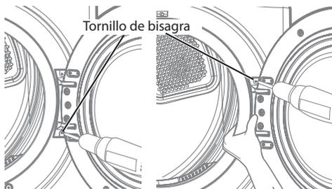
6. Extraiga la puerta de la cubierta de la secadora.
