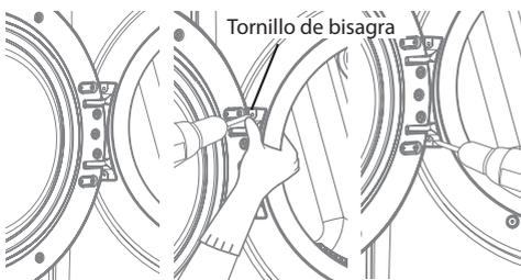
3. Inserte el pestillo en el lado derecho y atornille los tornillos del pestillo.
