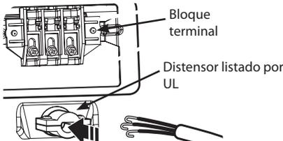
Cable eléctrico de 3 hilos listado por UL
