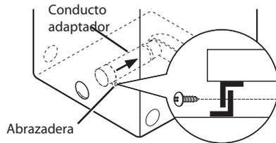
3. Inserte el codo de 4 pulgadas (10,2 cm) a través de la abertura trasera y presiónelo sobre el conducto adaptador. Asegúrese de que el extremo macho del codo apunte hacia abajo por el orificio ubicado en la parte inferior de la secadora. Asegúrelo en su lugar con cinta adhesiva impermeable. Conecte la placa de cubierta a la parte trasera de la secadora con el tornillo provisto.
