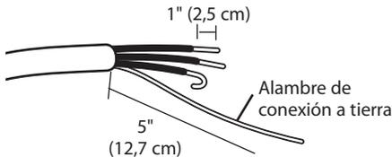
2. Quite la cubierta de acceso al bloque terminal localizado en la parte superior trasera de la secadora. Instale un distensor listado por UL en el orificio de paso del cable eléctrico; luego pase el cable eléctrico fabricado en el Paso 1 por el distensor.
