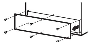
Retire la tapa flexible de plástico la válvula del agua (conexión del refrigerador).
