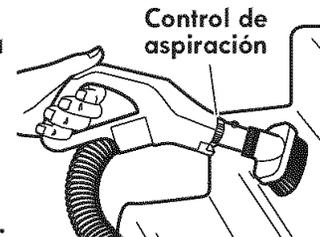
Mantenga el paso de aire abierto para lograr los mejores resultados de limpieza. Examine de vez en cuando cada una de las áreas de unión como se muestra en **REMOVER OBSTRUCCIONES** para asegurarse de que no existan bloqueos. Apague y desconecte la aspiradora antes de revisarla.
