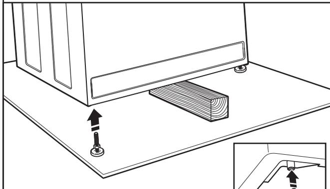
Visser les pieds dans les trous filetés au coin avant de la laveuse/sécheuse jusqu'à ce que les contre-écrous touchent la laveuse.
