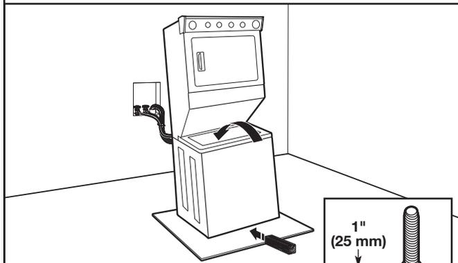
Relever l'avant de la laveuse/sécheuse d'environ 4" (102 mm) à l'aide d'un bloc de bois ou autre objet similaire que peut supporter le poids de la laveuse/sécheuse. Puis, visser le contre-écrou sur chaque pied à 1" (25 mm) de la base.
