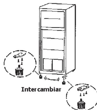
Extraiga la bisagra inferior al quitar la pata de nivelación y los tornillos en la parte inferior del armario del refrigerador. Para volver a colocar la bisagra en la parte opuesta del armario, primero quite la pata de nivelación. Vuelva a colocar la bisagra utilizando tornillos que se extrajeron anteriormente. Vuelva a colocar ambas patas de nivelación.
