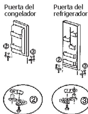
Extraiga el montaje del pasador de la parte inferior de las puertas del refrigerador y congelador. En el lado opuesto, acople el montaje del pasador de reemplazo (ubicado en la bolsa de plástico con el Manual de uso y cuidado) con un destornillador. Nota: Debe volver a utilizar el tornillo del montaje del pasador que se extrae en este paso cuando se sujeta el nuevo montaje.
