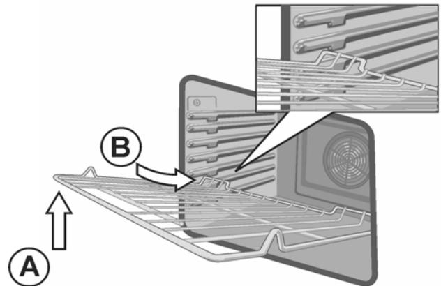
4. Mettre la grille à l'horizontale. Enfoncer la grille complètement à l'intérieur du four. La grille doit être droite et à plat. Elle ne doit pas être de travers.
