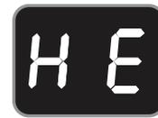
Figura 5: indicador de elemento caliente
