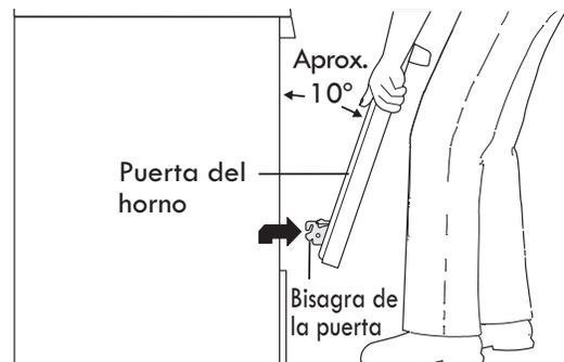
Figura 44: cómo sujetar la puerta para su extracción
