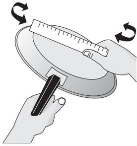
Figura 1: asegúrese de que el utensilio tenga fondo plano usando una regla.
