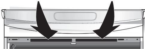
Figura 12: ubicación del respiradero del horno
