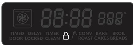
Figura 7: indicador de bloqueo de la cubierta
