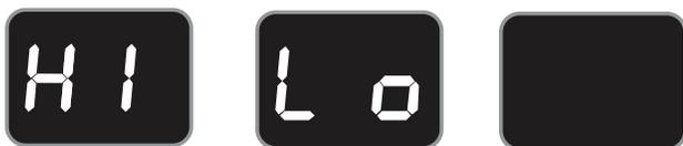
Figura 2: los ajustes de "Hi" (alto) a "Lo" (bajo) a "OFF" (apagado, pantalla vacía)
