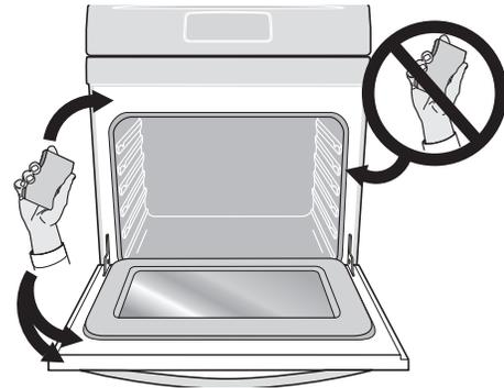
Figura 33: área de la puerta del horno con lo que se debe y no se debe limpiar (junta)
