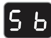
Figura 6: pantalla que indica que el horno está ajustado en modo sabático.
