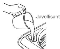
Le distributeur à javellisant dilue et distribue automatiquement le javellisant au moment approprié durant le cycle de lavage.
