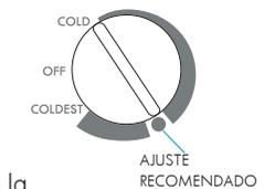
Nota: El giro del botón de control de temperatura a la posición OFF parará la circulación de refrigeración, pero no va a apagar la energía.
