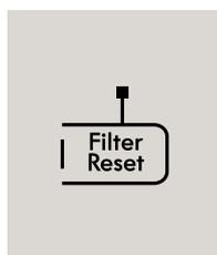
Tras 250 horas de funcionamiento, el indicador LED de " Reseteo del Filtro" se encenderá. Es un recordatorio para limpiar el filtro alojado tras el panel frontal y así mantener la unidad funcionando eficientemente. Al presionar el botón RESETEO DEL FILTRO durante 3 segundos este recordatorio se reseteará y el LED se apagará.
