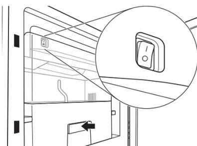
Loquet de déverrouillage du bac d'entreposage à glaçons
