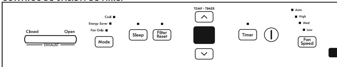
Este control de salida de aire permite al acondicionador reciclar el aire del interior de la habitación (CERRADO) o sacarlo al exterior (ABIERTO).
