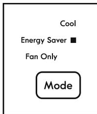
Ahorrrará energía usando el aparato en este modo. El compresor y el motor se apagarán una vez que la habitación esté a la temperatura seleccionada. Después la temperatura del aire será comprobada durante 20 segundos cada 10 minutos hasta que se eleve por encima de la selección, momento en el cual el compresor y el ventilador volverán a funcionar. El proceso completo se repetirá entonces.
