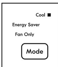
Nota: En este modelo, el ventilador permanece encendido todo el tiempo y el compresor se enciende y se apaga, según si se alcanza o no la temperatura de la habitación.
