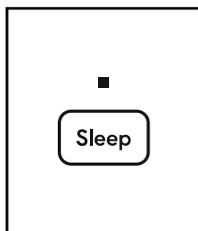
La temperatura seleccionada se incrementará en 2° F 30 minutos después de seleccionar esta función. Se volverá a incrementar de nuevo otros 2° F pasados otros 30 minutos. Permanecerá en este estado durante 7 horas, y después volverá a la configuración original.
