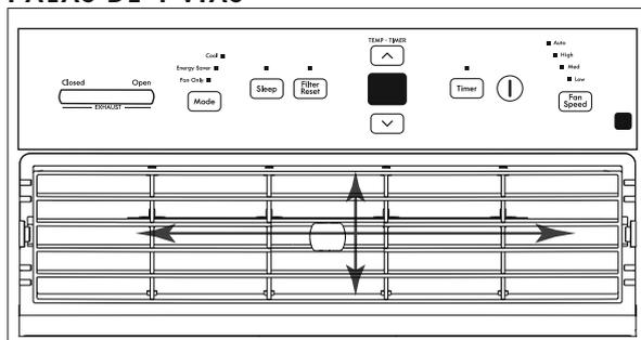
Las palas de direccionamiento del aire controlan la dirección del flujo de aire. Su acondicionador tiene el sistema direccional de 4 vías descrito a continuación.
