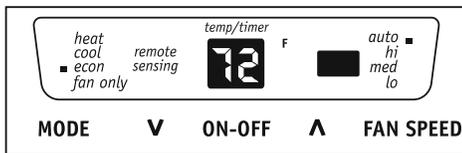
Nota: La unidad funcionará en modo de ahorro de energía (económico) cuando se utilice por primera vez. En este modo, el ventilador continuará funcionando durante 1 minuto después de que el compresor se cierre. Luego el ventilador realizará ciclos de 20 segundos con intervalos de 10 minutos cada uno hasta que la temperatura de la habitación supere la temperatura establecida, en ese momento, el compresor volverá a encenderse.
