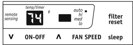
Nota: Pulse una vez o mantenga presionado tanto el botón arriba ( ▲ ) como el botón abajo ( ▼ ) hasta que se muestre la temperatura deseada en la pantalla. Esta temperatura se mantendrá automáticamente entre 60 °F (16 °C) y 90 °F (32 °C). Si quiere que la pantalla muestre la temperatura actual de la estancia, consulte la sección "Para operar sólo en modo ventilador" en la página 7.
