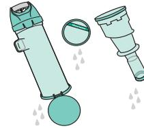
Tire de la aldaba para levantar la tapa. Saque el filtro de espuma y la pantalla del filtro; sacuda el polvo. Enjuague el filtro de espuma, la pantalla y el recipiente para el polvo. Seque todo muy bien.
