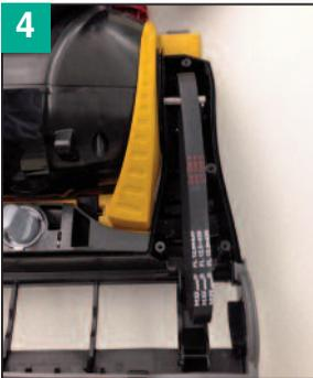
4 Retire la banda del eje del motor y del cepillo de rodillo.
