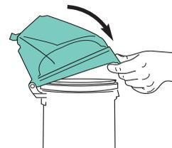
Alinee las lengüetas de la pantalla del filtro con las ranuras de la parte posterior del recipiente. Déjala caer en su posición. Vuelva a instalar el filtro de espuma y cierre la tapa.
