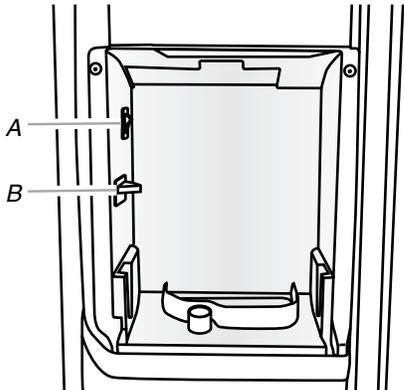
A. Interruptor de On/Off (Encendido/Apagado)
