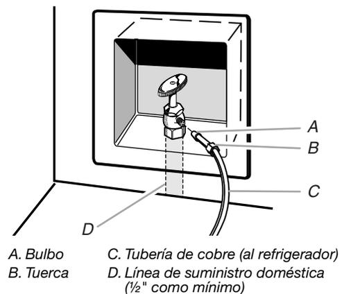
4. Ahora está listo para conectar la tubería de cobre a la válvula de cierre. Use tubería de cobre blando de ¼" (6,35 mm) de diámetro exterior, para conectar la válvula de cierre y el refrigerador.
