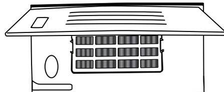
4. Cierre la puerta con orificios de ventilación.
