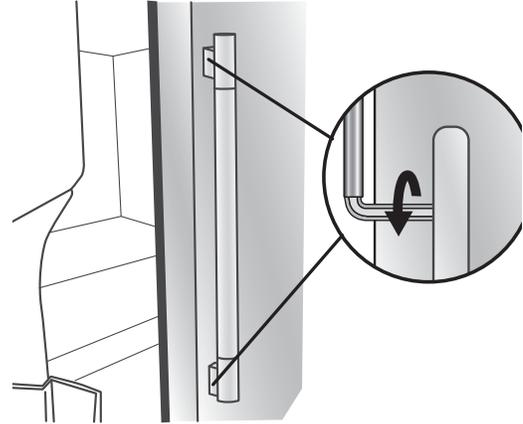
5. Con un movimiento de reloj, apriete el tornillo opresor hasta que comience a hacer contacto con el tornillo de tope.
