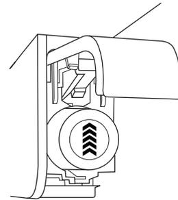
1. Ubique el filtro de agua que está ubicado en la esquina superior derecha del compartimento del refrigerador.
